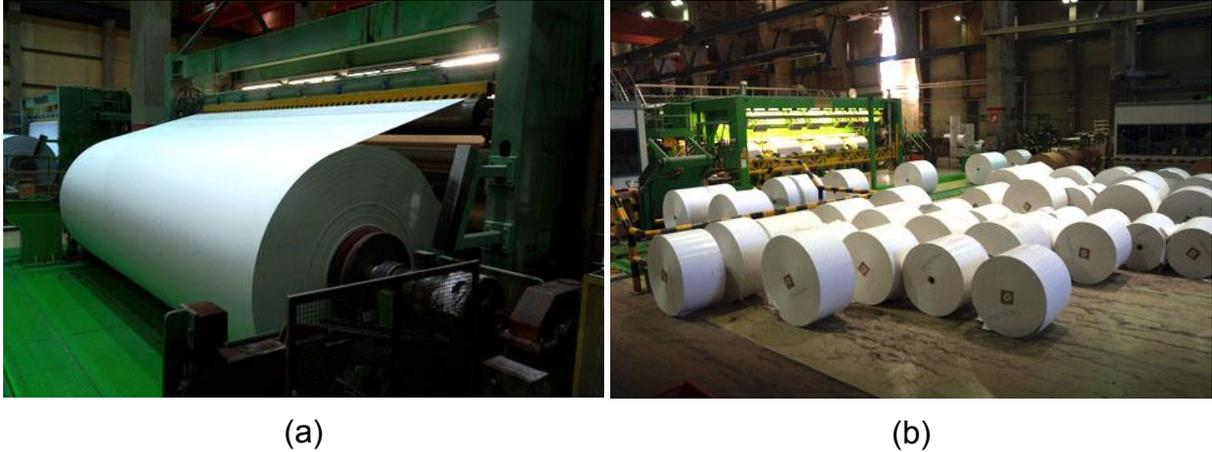
**Figura 8** – (a) Bobina jumbo em processo de corte;
