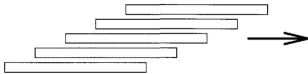
Figura A.2: Esquema de um escoamento dito laminar [29]
