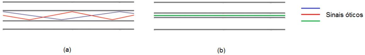
Figura 2.4: Propagação de sinais óticos em uma fibra multimodo em (a) e em uma fibra monomodo em (b). Fonte: adaptado de [41].
