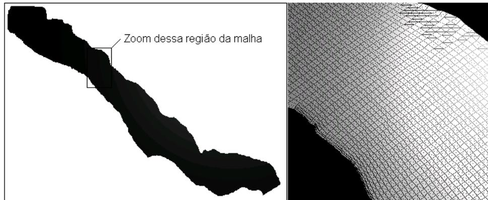
Figura 3.3: Modelagem da geometria discreta do lago Igapó 1
