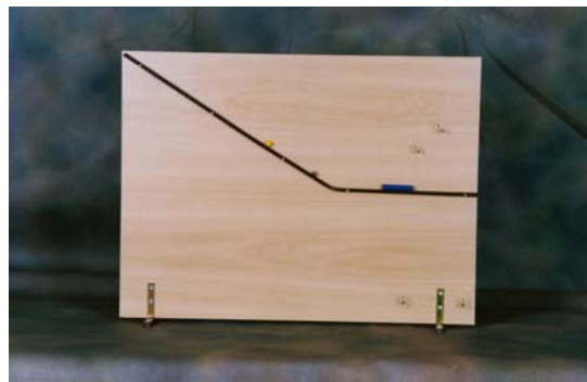
Foto 4. Modelo de placa contendo trilho com uma parte inclinada e outra horizontal onde é colocado um bastão de madeira. As esferas de metal e de plástico colocadas no trilho devem deslocar o bastão à mesma distância.
