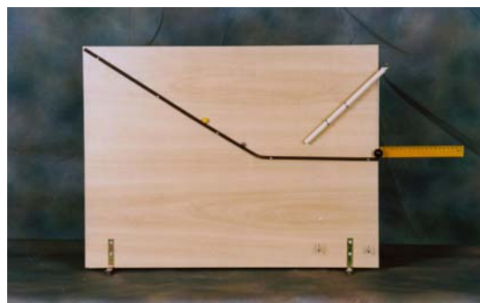
Foto 2. Modelo de placa contendo trilho, pêndulo de madeira e régua para medida. As esferas de metal e de plástico colocadas no trilho devem deslocar o pêndulo à mesma distância.
