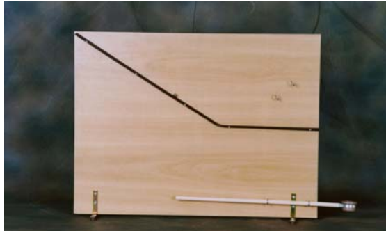
Foto 1. Modelo de placa contendo trilho com cestinha acoplada na parte inferior. A esfera colocada no trilho deve cair dentro da cestinha.
