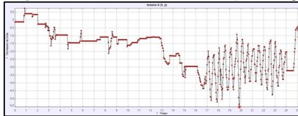
Imagem 16: Deslocamento da mola em função do tempo
