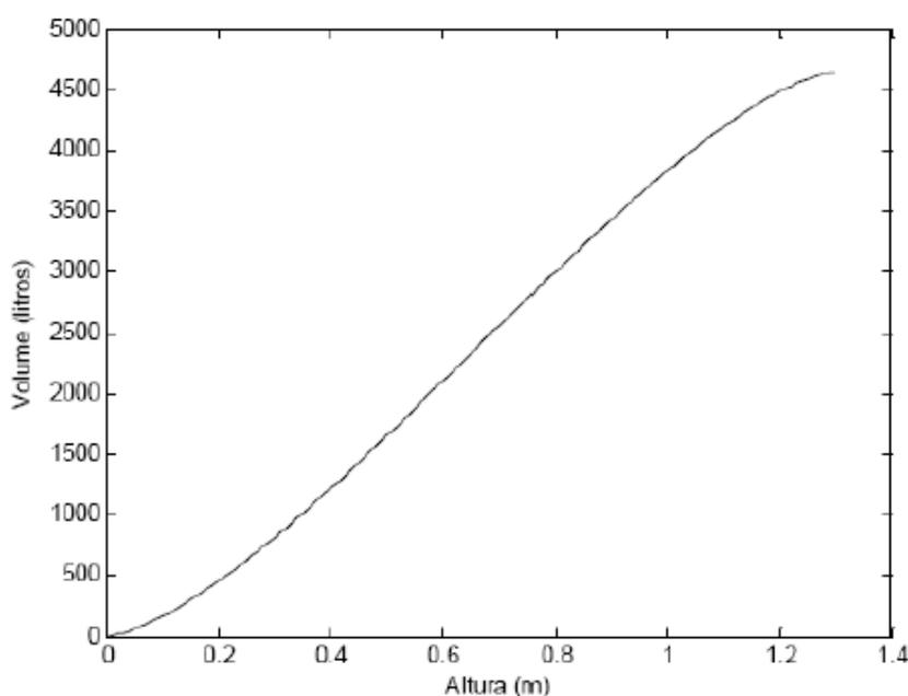
Figura 4.18 – Volume em função da altura do tanque cilíndrico, para  $R=0,65m$  e  $L=3,5m$ .
