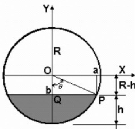
Figura 4.17 – Seção transversal do tanque cilíndrico de combustível.
