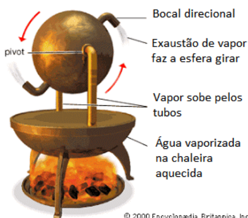
Figura 7 - Modelo de aeolípia (ou máquina de Heron). Fonte: Encyclopædia Britannica, 2016
