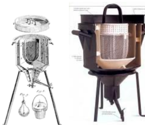
Figura 9 - Esquema do Calorímetro de Lavoisier e Laplace.
