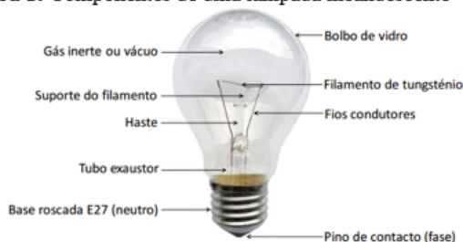
Figura 1: Componentes de uma lâmpada incandescente
