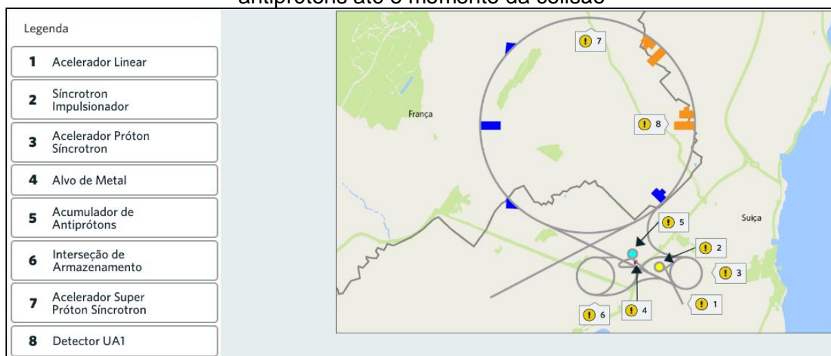
Figura 14 – Representação do processo de produção e aceleração de prótons e antiprótons até o momento da colisão
