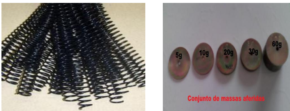
Figura 3. Ilustração das espirais de encadernação usadas como mola e massas aferidas.
