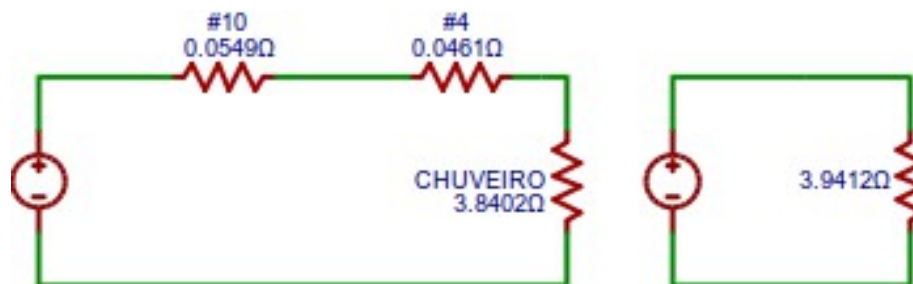
Fig.52- Circuito Série de um chuveiro com cabo #4
