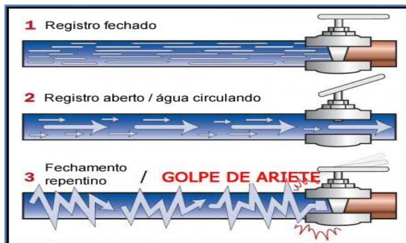
Figura 7. Ilustração da formação do fenômeno golpe de aríete ( https://pt.linkedin.com/pulse/voc%C3%AA-sabe-o-que-%C3%A9-golpe-de-ariete-e-consequ%C3%AAs-cias-por-instruflow )
