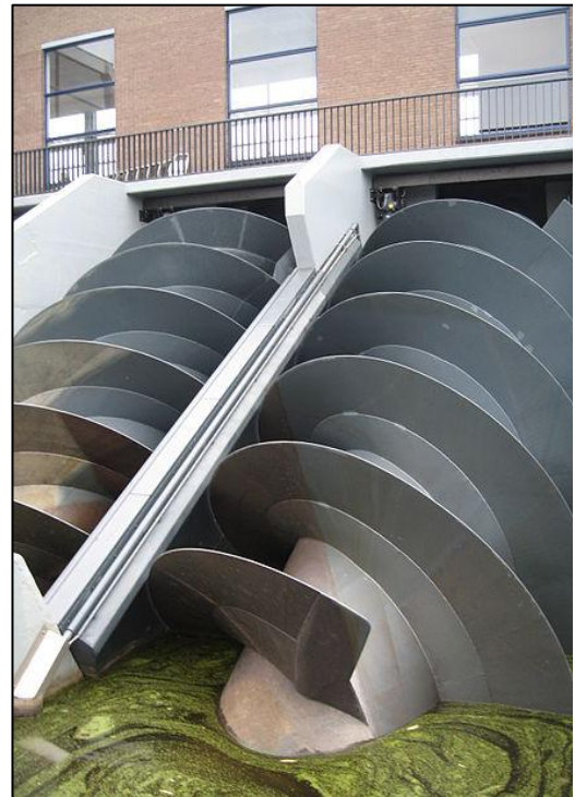
Figura 3. Parafuso de Arquimedes moderno usado para drenar áreas de plantio alagadas nos Países Baixos. (foto: M.A. Wijngaarden / Wikimedia Commons / CC BY-SA 2.5 )
