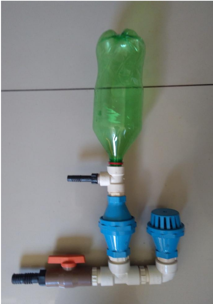
Figura 15: Carneiro com válvula em PVC montado pelo autor
