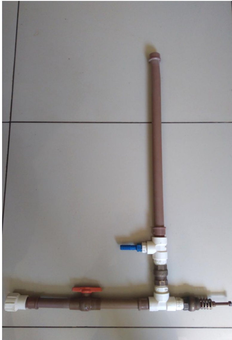
Figura 14: Carneiro hidráulico com válvula de metal montado pelo autor
