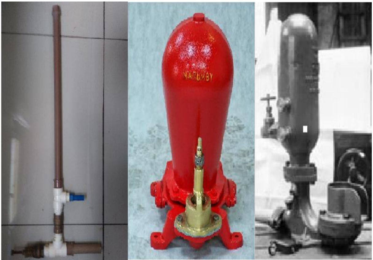
Figura 11. A esquerda, modelo montado pelo autor, ao centro versão moderna da bomba carneiro Marumby, à direita, Green&Carter. (marumby, 2017) (green&carter, 2017)
