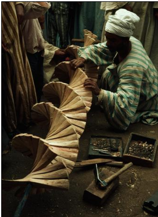
Figura 2. Egito, parafuso de Arquimedes, construído artesanalmente para atender aos agricultores das margens dos rios e canais . (foto: M.A. Wijngaarden / Wikimedia Commons / CC BY-SA 2.5 )
