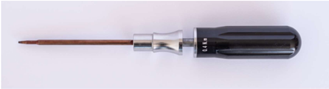
Figura 6 – Chave de aperto com torque pré-estabelecido para 0,4 Nm.
