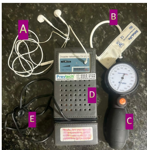
Figura 1- Aparelho Doppler vascular com fone de ouvido acoplado. (A) Fone de ouvido estéril Apple EarPods Intra-Auricular com Conector 3,5 mm - MWU53BZ/A. (B) Manguitos de pressão arterial DeltaLife. (C) Esfigmomanômetro Clínico Incoterm. (D) e (E) detector de fluxo ultrassônico Doppler Veterinário modelo DV 610V.
