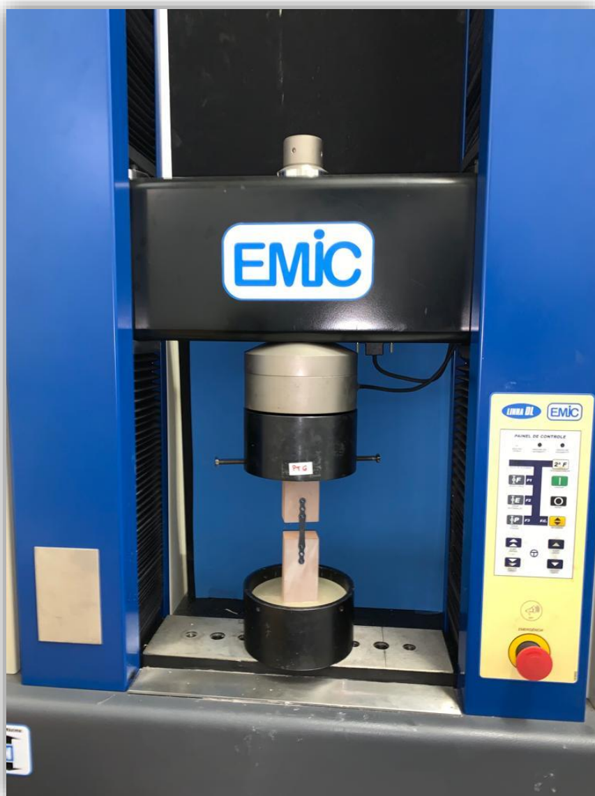
Figura 5: Máquina de ensaios universal EMIC® com corpo de prova acoplado.
