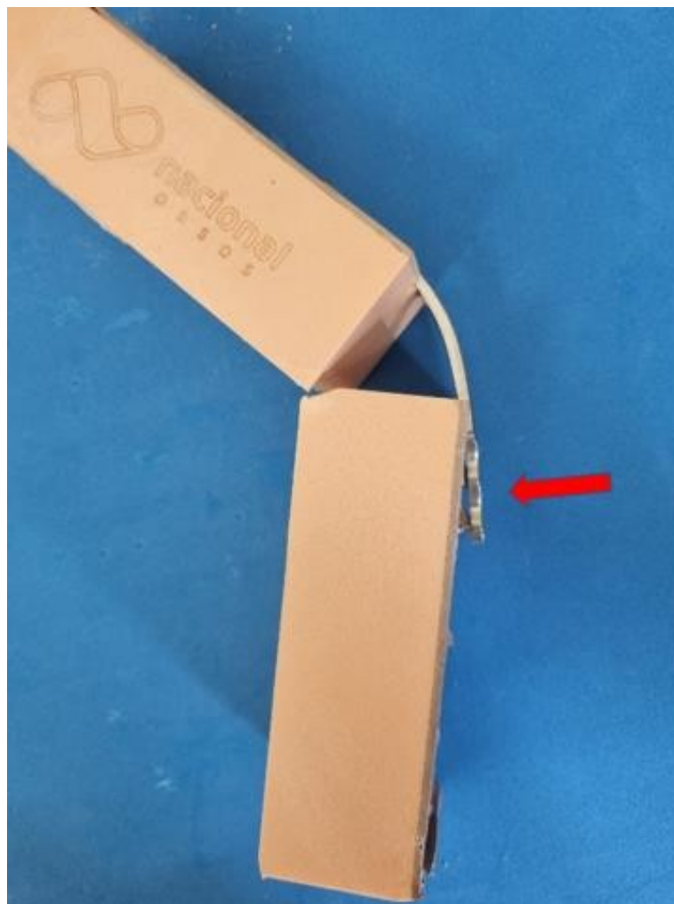
Figura 13: Imagem fotográfica da montagem A3 após o ensaio mecânico de compressão axial. Nota-se o arrancamento parcial dos parafusos do bloco distal (seta vermelha).
