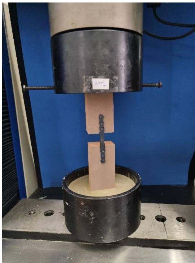
Figura 10: Imagem fotográfica da montagem de titânio número 1 (T1) fixada à máquina de ensaios universal.
