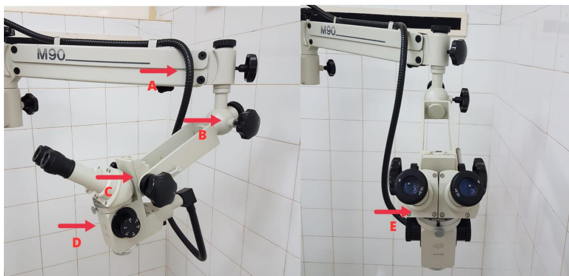
Figura 2- Ajuste do microscópio cirúrgico M90 DFVasconcellos: A- Braço sobe e desce; B- Direita e esquerda; C: Ajuste fino; D: Aumentos; E: Ajuste interpupilar
