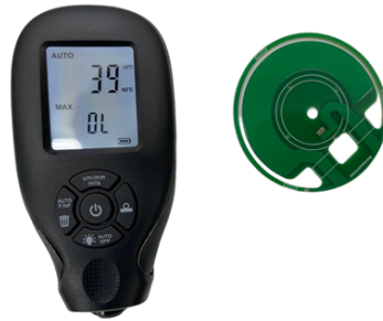
Figura 52: Medição da espessura de tinta.
