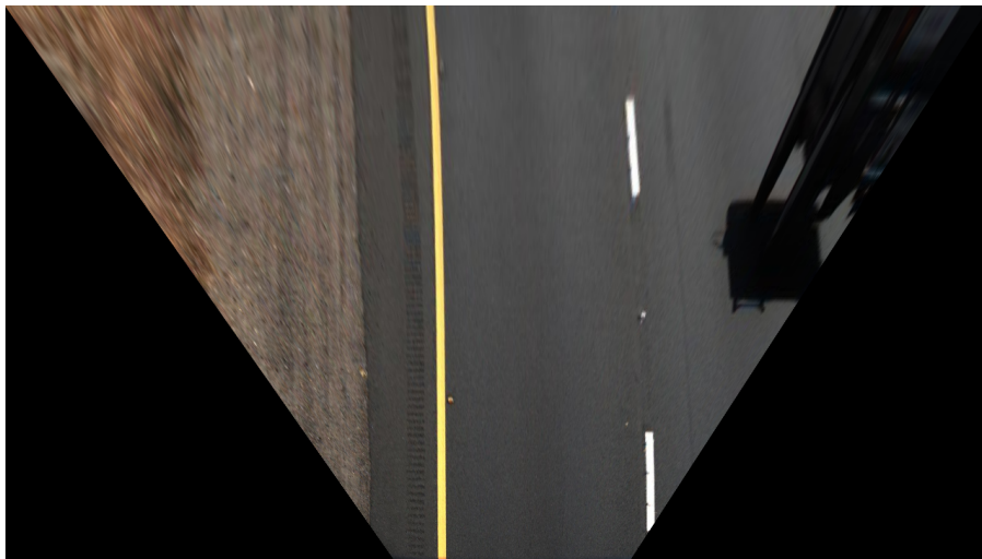
Figura 2.5: Exemplo de imagem em BEV obtida pela operação IPM na Figura 2.3.
