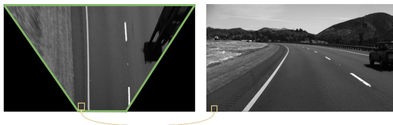
Figura 4.10: Imagem ilustrativa da região utilizada na transformação IPM. As retas em verde limitam a região válida. Em amarelo é representado a transformação de um elemento da imagem destino.
