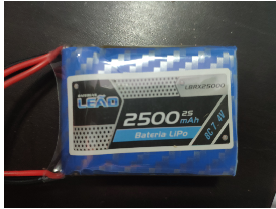
Figura 4.3: Bateria LiPo de 7,4 V e 2500 mAh.
