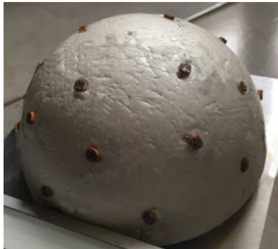
Figura 3.13: Superfície de isopor com os LDRs posicionados.
