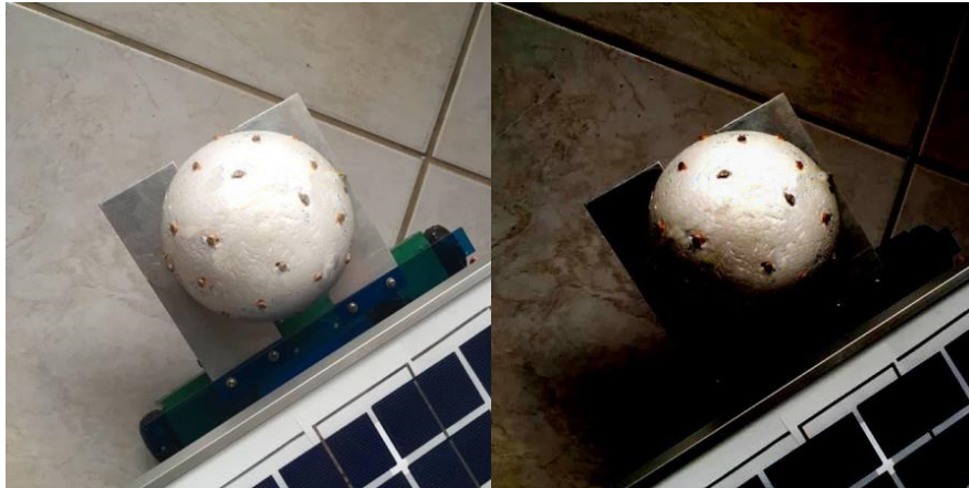
Figura 4.4: Vista superior dos LDRs na amostra atual. Foto original e com contraste.
