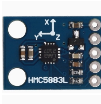
Figura 3.10: Placa de circuito da bússola digital.
