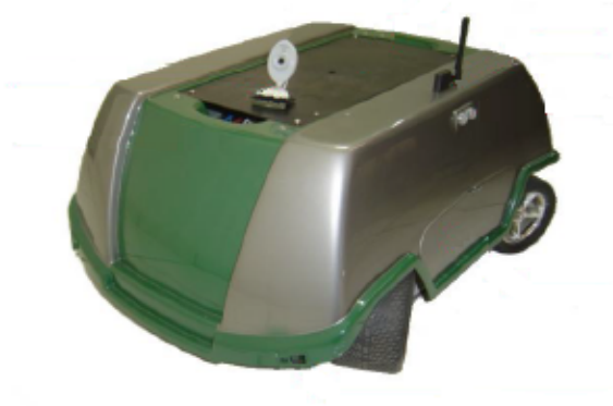
Figura 3.1 – Plataforma Robodeck (plataforma robótica móvel desenvolvida pela empresa XBOT).
