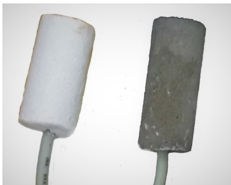
(a) Ponteiros inseridas em blocos de gesso e cimento - 25,4 mm x 50 mm.
