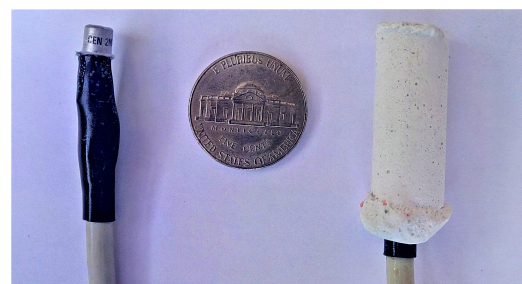
(b) Ponteiros sem encapsulamento e inserida em bloco de gesso - 12,7 mm x 30 mm.
