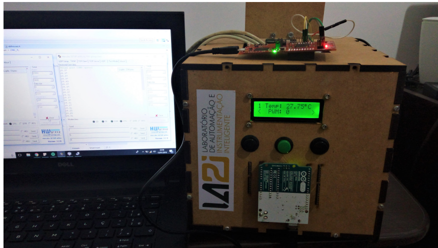
Figura 4.3: Ensaio realizado em câmara térmica para avaliação das ponteiras como sensores de temperatura.
