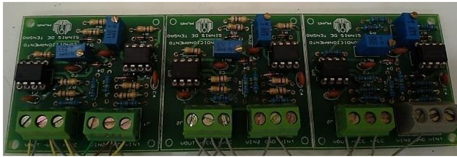
Figura 115 – Fotografia da placa de condicionamento de tensão. Fonte: Autor.
