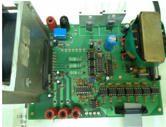
Figura 122 - Fotografia da placa do inversor monofásico. Fonte: Autor.
