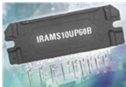
Figura 26- Módulo IRAMS10UP60A. Fonte: Autor.
