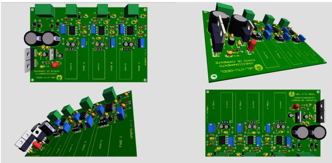
Figura 116 - Modelo da placa de condicionamento de corrente em 3D. Fonte: Autor.
