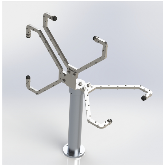
Figura 3.8 – Anemômetro projetado em software de modelagem 3D com topologia ortogonal.
