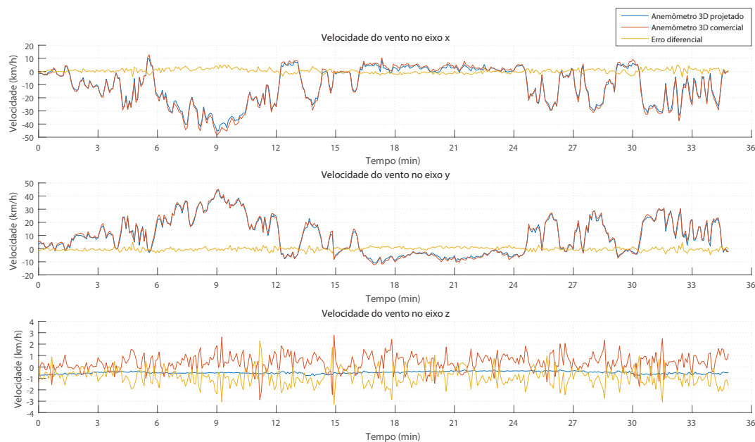
Figura 4.18 – Teste com o anemômetro ortogonal posicionado com eixo X á 45^\circ da frente do automóvel.
