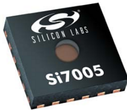
Figura 3.21: Sensor de umidade e temperatura da Silicon Labs®.
