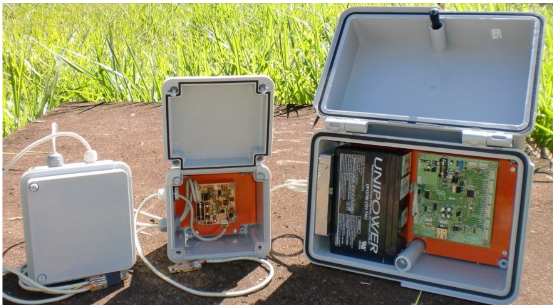
FIGURA 3. Equipamento montado em caixas com fator de proteção IP 65 e IP 67.
