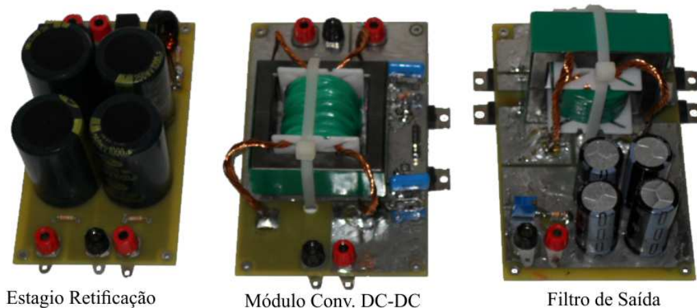
Figura 2.14: Módulos do Carregador de Baterias
