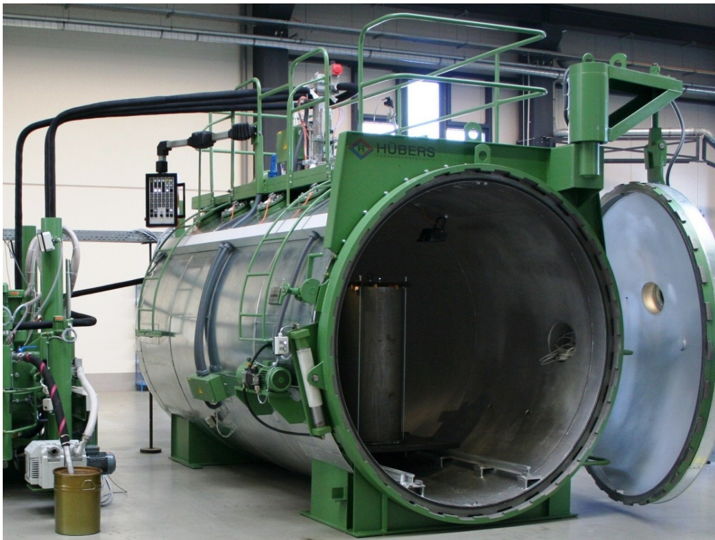
Figura 4 - Autoclave para encapsulamento de bobinas (Fonte: Hübers)
