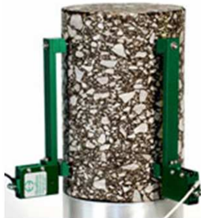
Figura 2.12: Instrumento extensômetro elétrico instalado em corpo de prova. Este instrumento pode ser instalado na superfície em alvenaria ou corpo de prova, gerando sinal elétrico proporcional à deformação obtida. Fonte: (EPSILON, 2013).
