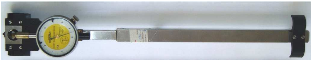
Figura 2.11: Instrumento extensômetro mecânico. Esta ferramenta é instalada entre as estruturas avariadas, permitindo uma leitura de valores da abertura de fissura diretamente no mostrador analógico. Fonte: (MASTRAD, 2012).
