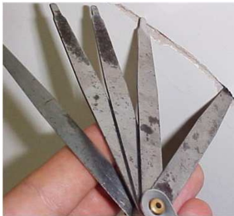
Figura 2.10: Calibrador de lâminas para medição da abertura de fissura. Este instrumento numa medição convencional permite uma verificação comparativa entre a abertura da fissura em alvenaria e a espessura da lâmina. Fonte: Próprio autor.
