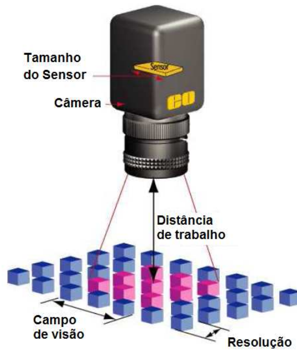
Figura 2.3: Representação de uma câmera e sensor, com o parâmetro da distância de trabalho, o campo de visão e resolução. Fonte: Traduzido de (EDMUND, 2012).
