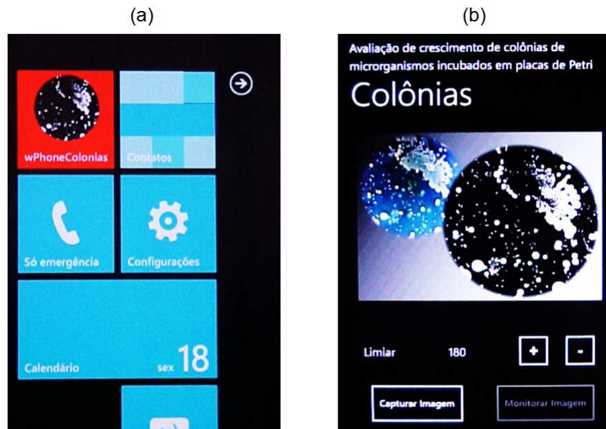
Figura 3.16: Processamento de uma imagem da placa de Petri no aparelho celular com o sistema Windows Phone : (a) Tela inicial do aparelho celular com o ícone WphoneColonias ; (b) Seleção do sistema e do limiar para o processamento da imagem a ser capturada. Fonte: Próprio autor.
