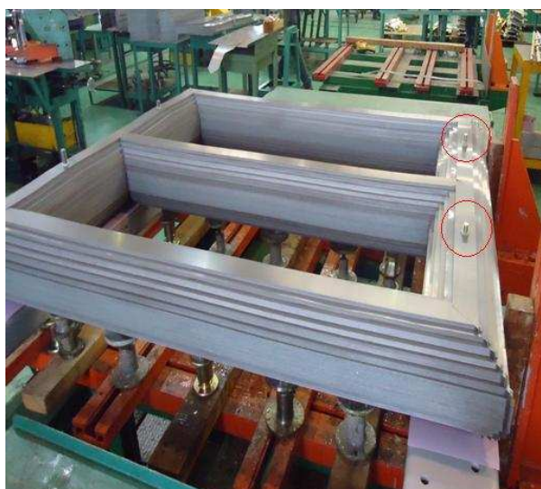
Figura 4.10: Núcleo Multi Step-lap e tirantes após aperto.
