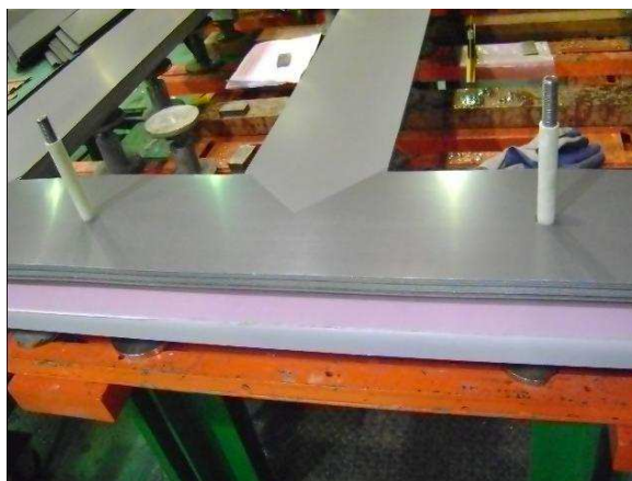
Figura 4.9: Detalhe da furação nas chapas do núcleo Multi Step-lap e montagem dos tirantes.
