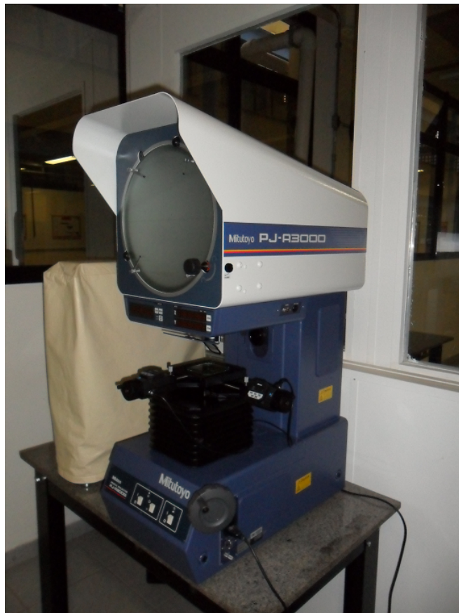
Figura 5.4: Projektor de perfil PJ-A3000 Mitutoyo.
