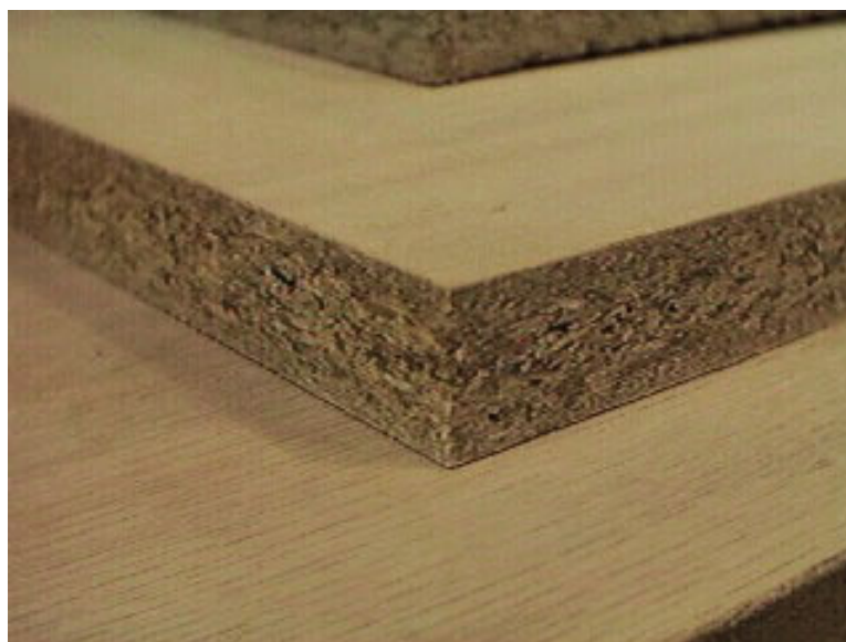
Figura 2.10: Aspecto da chapa de madeira reconstituída do tipo MDP, fonte Duratex (2010).
