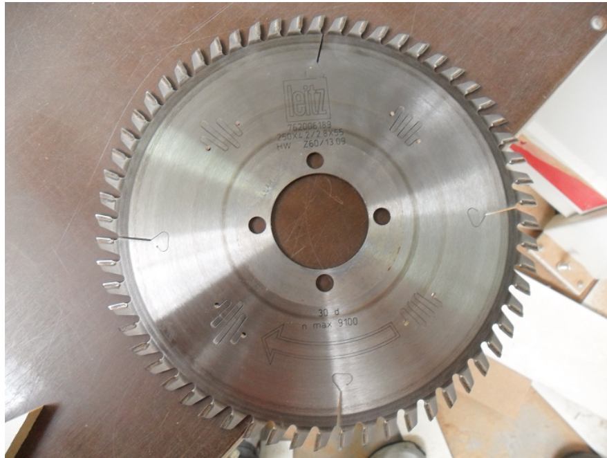
Figura 6.4: Serra utilizada para o seccionamento de placas de madeira reconstituída pela empresa LUAH Móveis Planejados.
