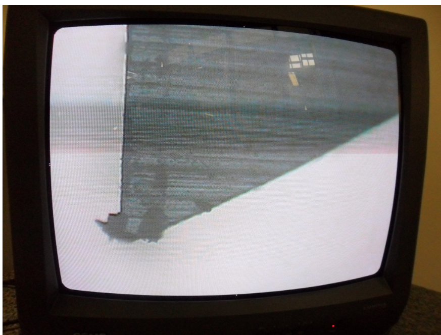
Figura 8.9: Aferição da aresta cortante antes da utilização.
