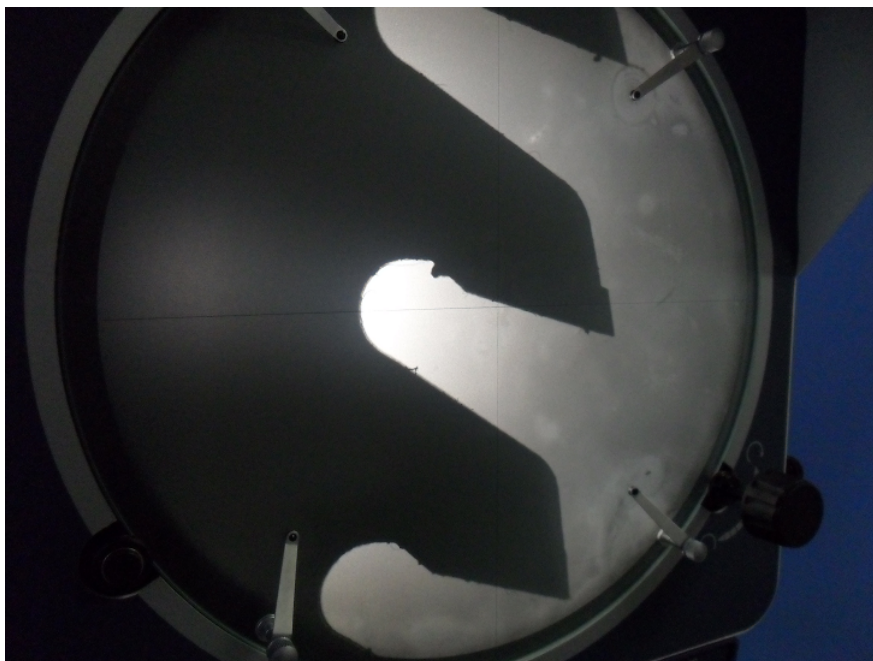
Figura 8.8: Aferição do ângulo da serra antes da utilização.
