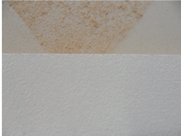
Figura 7.2: Borda de uma chapa de MDF em perfeito estado após o corte.
