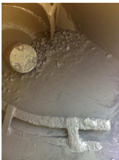
Figura 4.3: Mistura de concreto com segregação evidente.
