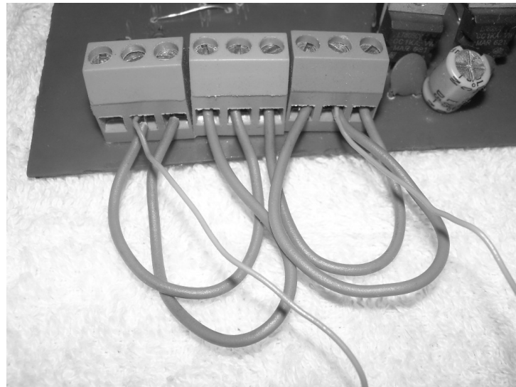
Figura 30: Vista da implementação do conector de parafusos utilizado para as conexões dos extensômetros
