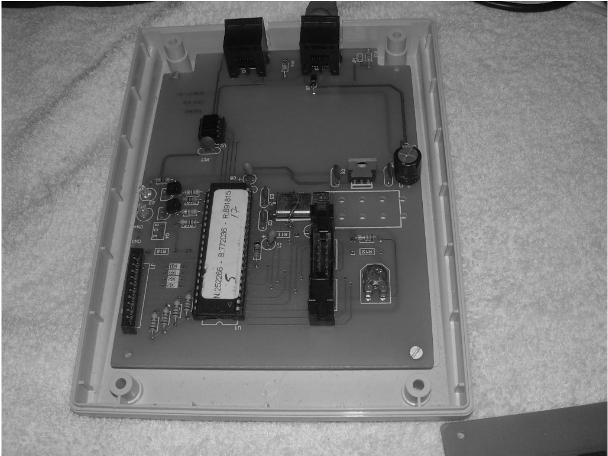
Figura 53: Fotografia da primeira versão do terminal de rede implementado no microcontrolador AT89S8252 para validação do protocolo MODBUS
