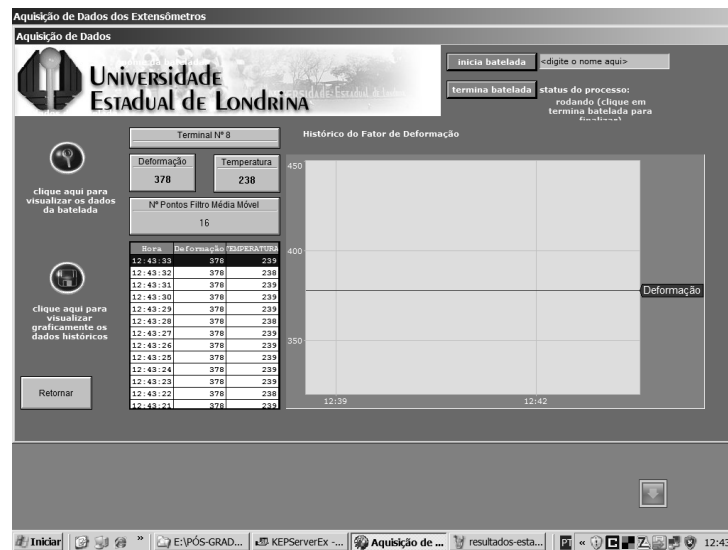
Figura 96: Tela de coleta de dados mostrando estabilidade com o passar do tempo (regime permanente)
