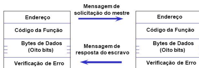
Figura 44: Esquema de Troca de Mensagens entre Mestre e Escravo no protocolo MODBUS
