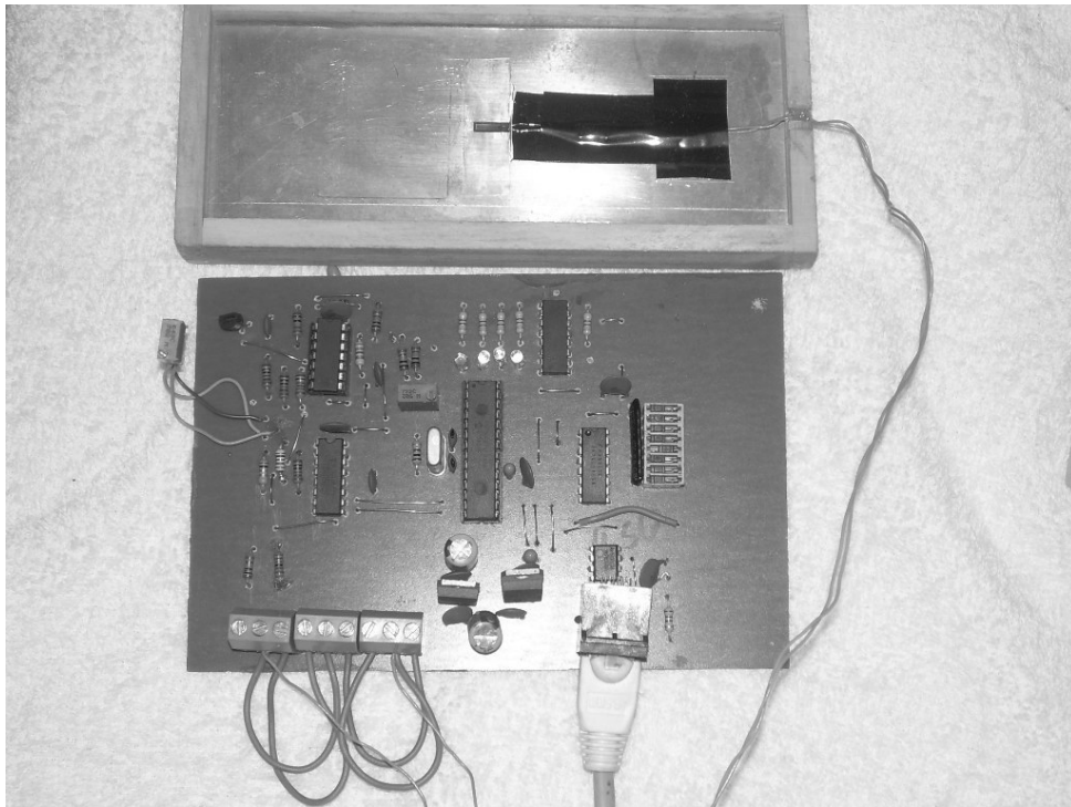
Figura 91: Extensômetro elétrico ligado em configuração de 1/4 de ponte utilizado para o experimento
