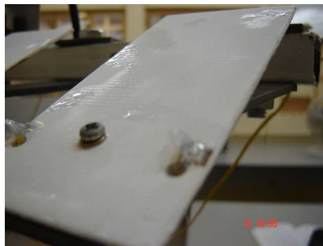
(c) Sensor coberto com tinta esmalte e recoberto com tinta latex ( CapLTx\#(3, 4) );
