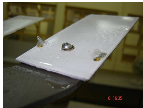
(d) Sensor coberto com tinta latex ( ResLTx\#(7, 8) ).
