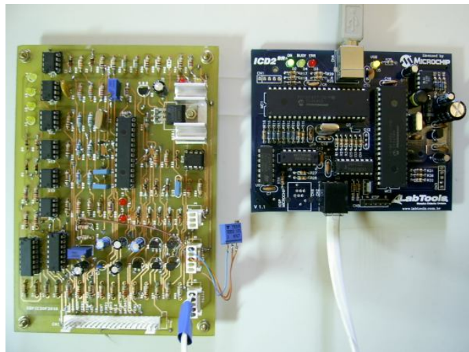
Figura 113 – Placa de controle digital DSC e ICD2 BR interligados.
