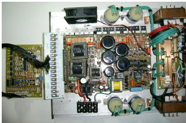
Figura 116 – Placa potência, interface chaves e controle digital interligados.
