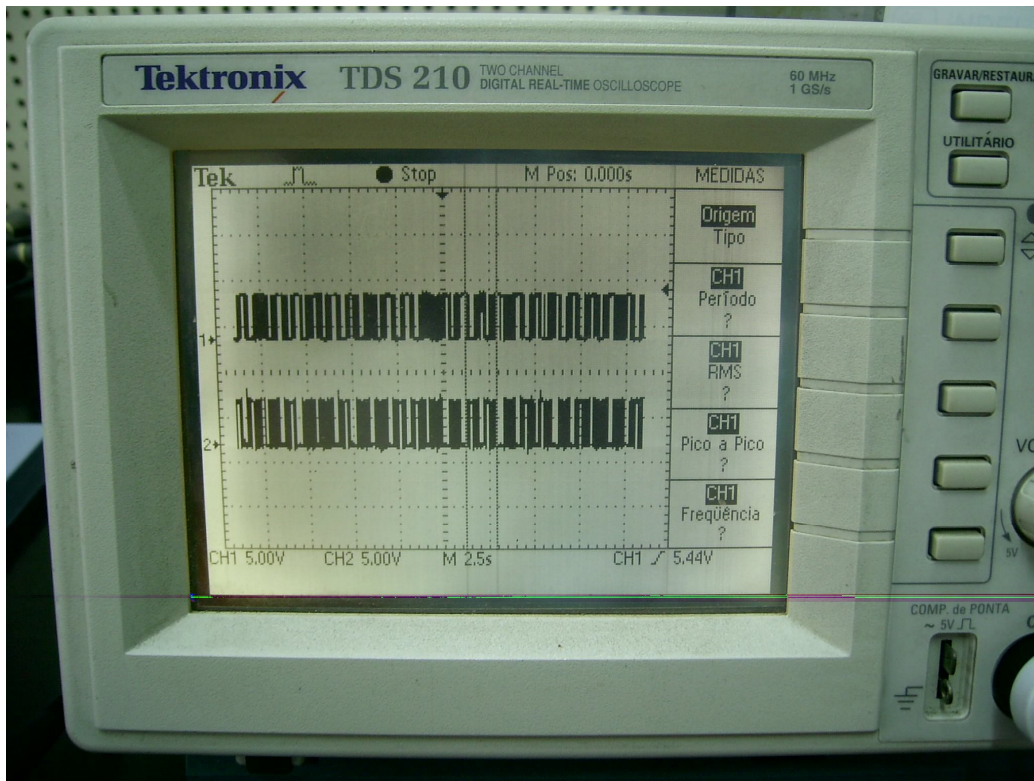
Figura 120 – Pulsos PWM para o inversor.
