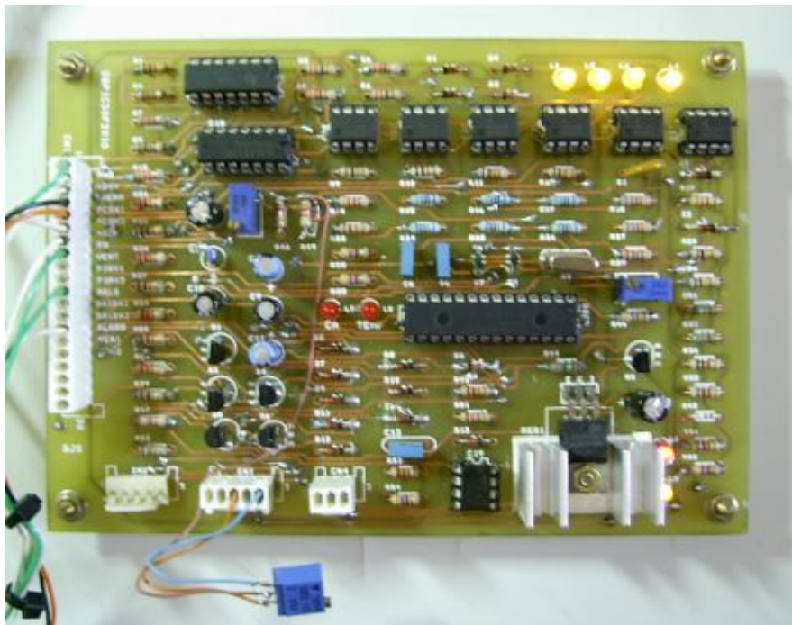
Figura 103 – Foto da placa de controle digital com DSC.
