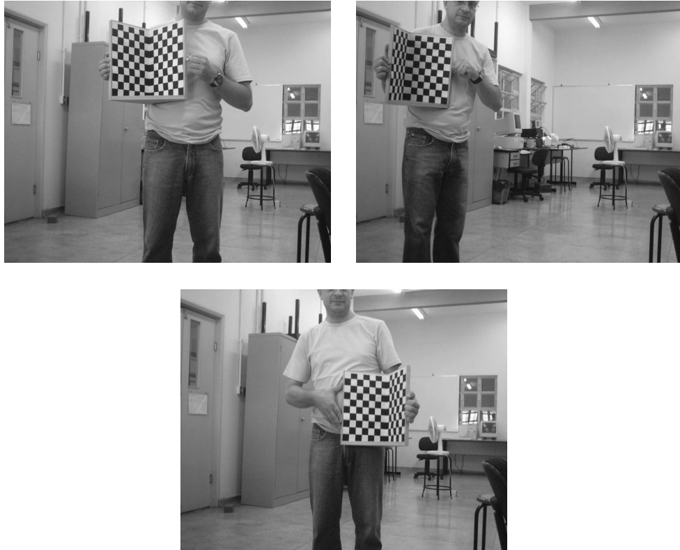
Figura 4.11 – Três exemplares da seqüência de imagens-teste utilizada na avaliação do algoritmo de calibração automática com deslocamentos euclidianos.
