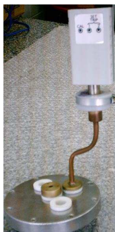
Figura 3.23: Conexão do medidor Pirani à tampa superior
