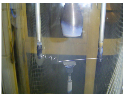
Figura 4.1: Filamento de 0,38 mm de diâmetro, com mola esticadora
