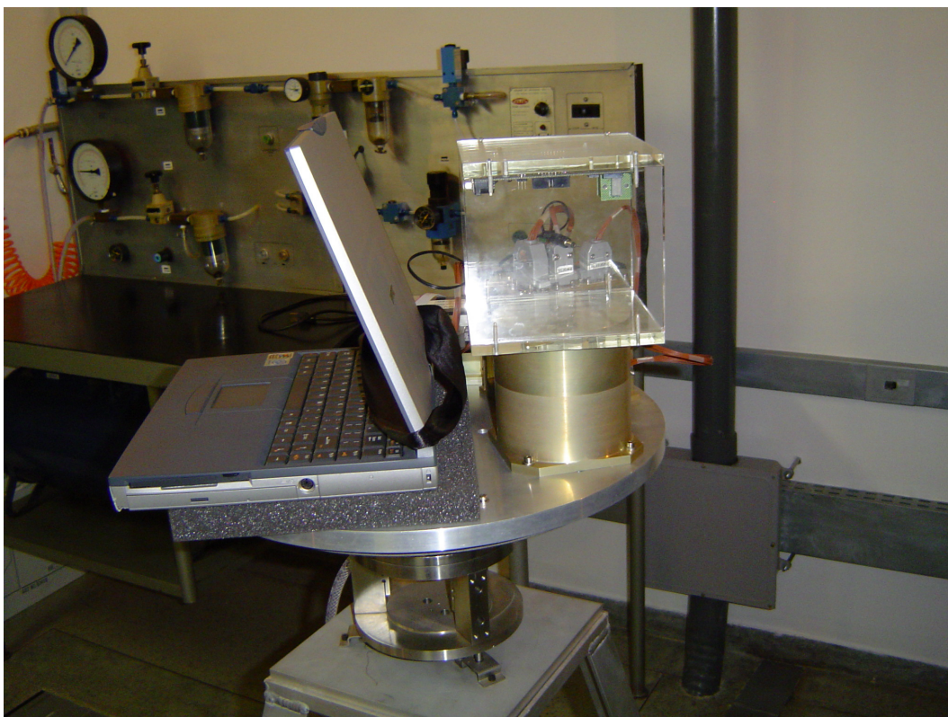
Figura 6.38 – A segunda foto traz todo o sistema, inclusive o notebook de aquisição sobre o prato da mesa de mancal a ar de um eixo.
