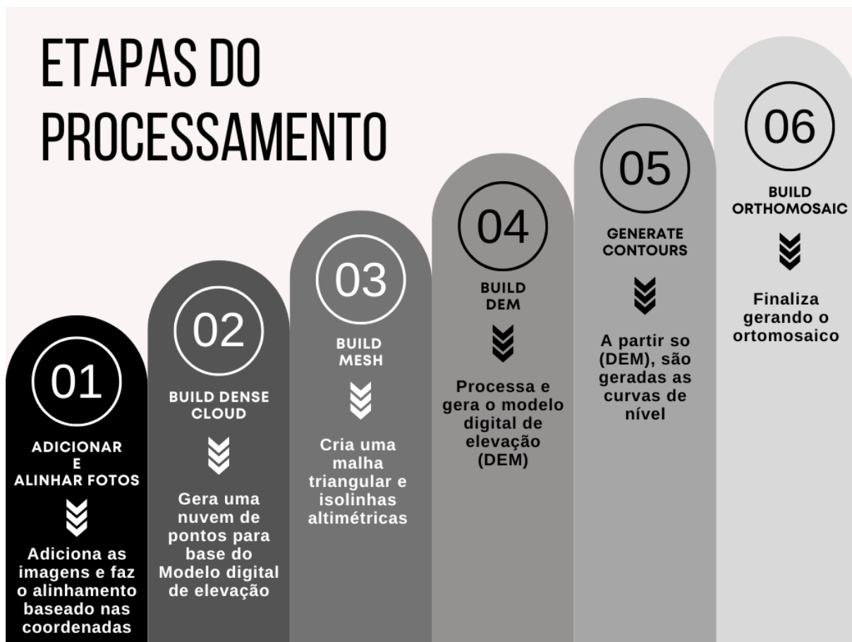
Figura 29: Etapas do processamento no software Agisoft Metashape
