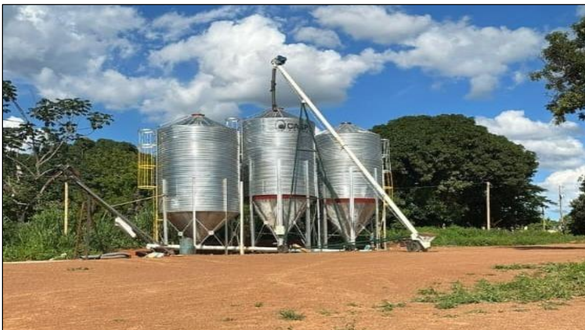
Figura 56: Condutores móveis de descarga elevada em silos de ração para peixe.
