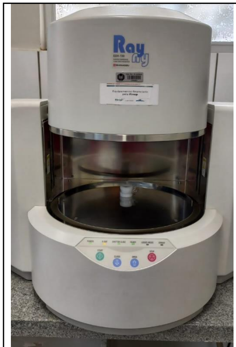
Figura 22- Espectrofotômetro de fluorescência de raio-X EDX 720 do Laboratório de Análises por Técnicas de Raios X- LARX da UEL.
