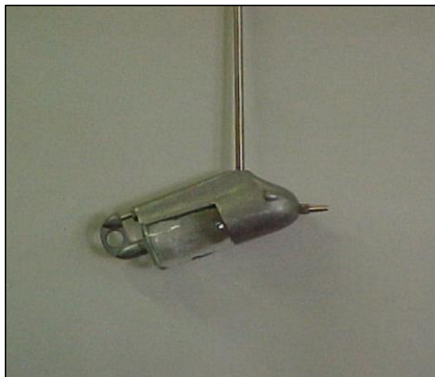
Figura 21. Amostrador isocinético tipo US-DH-48 utilizado para coleta da água e sedimentos durante os eventos de precipitação.
