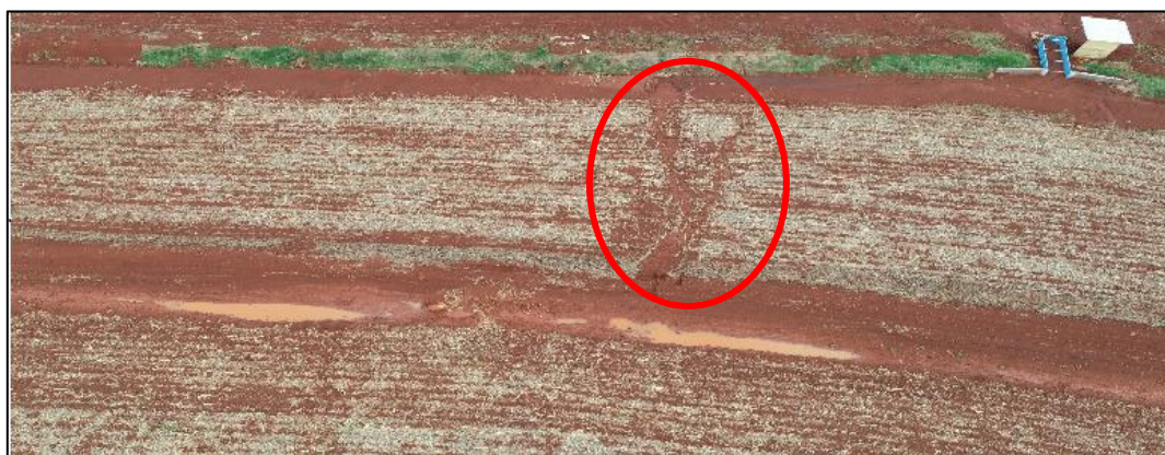
Figura 71. Rompimento de terraço observado após evento pluviométrico.
