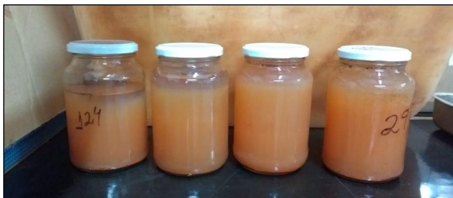
Figura 22. Recipientes de coleta e armazenamento das amostras de água durante os eventos de chuva.
