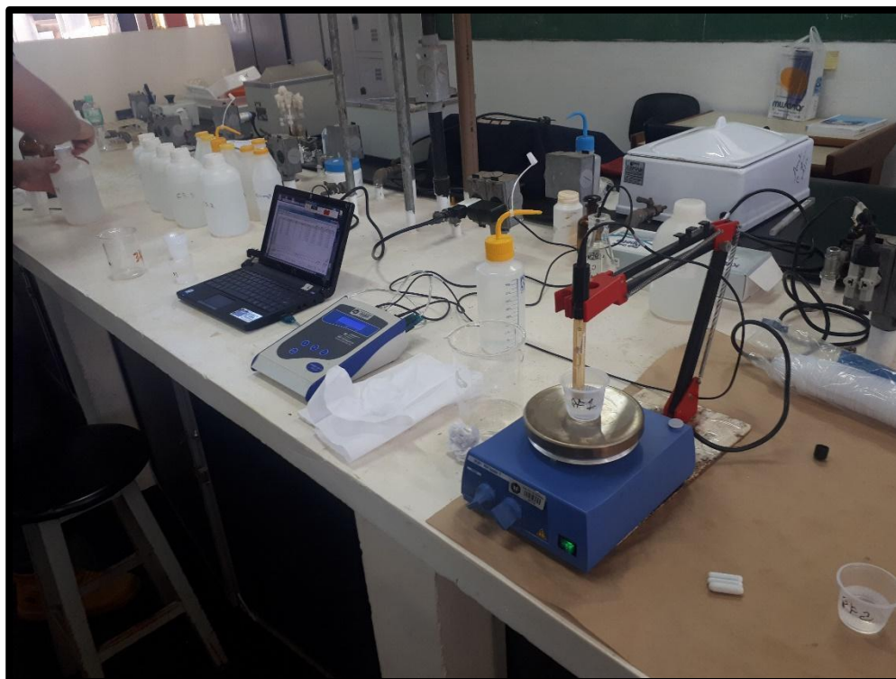
FIGURA 7.1 - POTENCIOMETRIA DIRETA COM ELETRODO SELETIVO PARA ÍONS DE FLUORETO.
