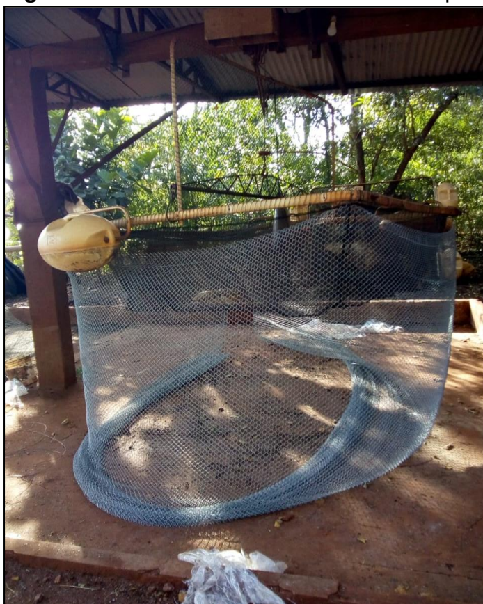
Figura 52: Momento da troca de tela de tanque-rede por malha de aço-inox.
