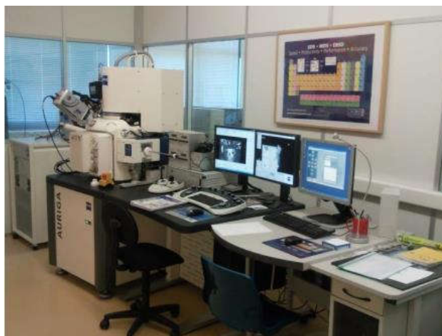
Figura 17 – Sistema SEM-FIB Cross-Beam Auriga, localizado no Laboratório de Nanofabricação, no CENIMAT.
