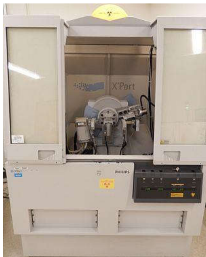
Figura 18 – Sistema X'Pert PRO MPD, localizado nas instalações do CENIMAT.
