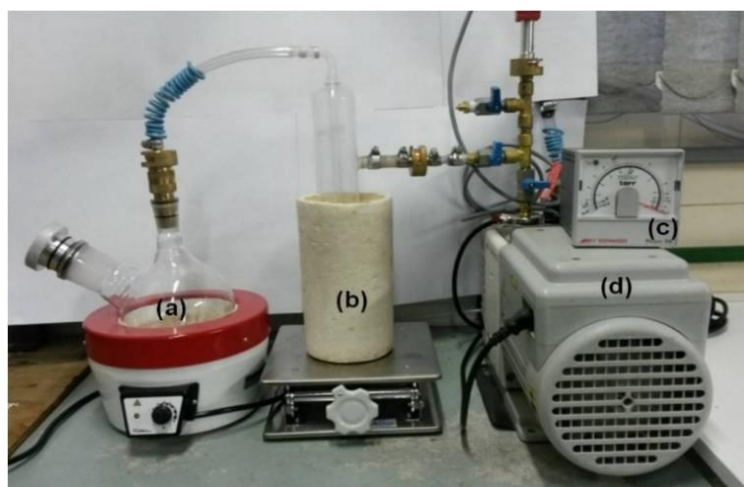
Figura 6 - Sistema para extração do eletrólito à vácuo: (a) balão contendo o “rocambole” de eletrodos, (b) armadilha de nitrogênio, (c) medidor de vácuo e (d) bomba de vácuo mecânica
