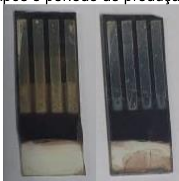
Figura 26 – Lado esquerdo: fotografia de uma amostra degradada que foi iluminada durante a caracterização elétrica e armazenada no escuro em ar úmido. Lado direito: fotografia de uma amostra que não foi iluminada e foi armazenada em uma embalagem que a protegia do contato com a umidade do ar. As fotografias foram feitas 21 dias após o período de produção das amostras
