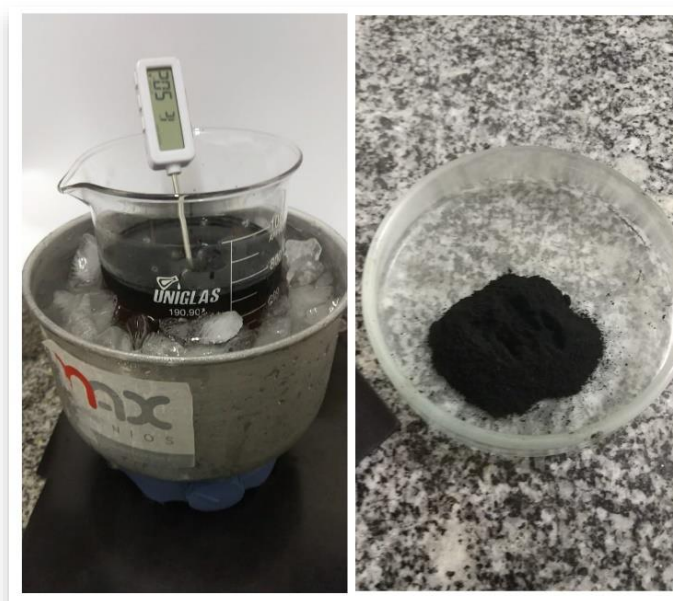
Figura 11 - Sistema utilizado para a obtenção da PANI e o material obtido da síntese. Fonte: do autor.
