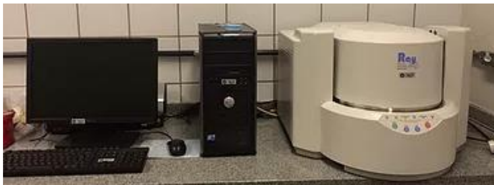
Figura 9 – Equipamento EDX - 720 da Shimadzu no LARX-UEL.
