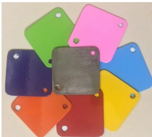
Figura 7 – Placas de aço pintadas com a tinta pó e uma placa sem aplicação de tinta.
